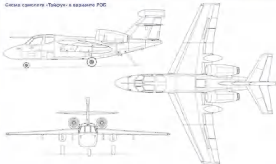
Схема самолета «Тайфун» в варианте РЭБ
